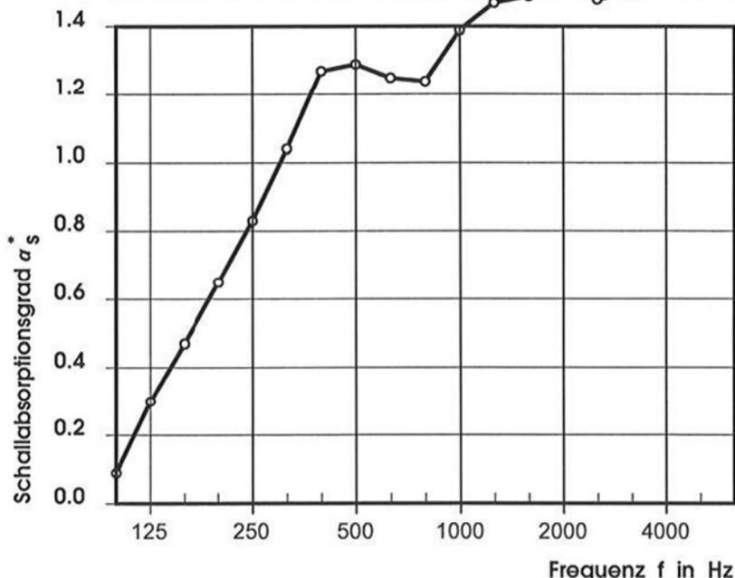
Bewertung in Anlehnung an DIN EN ISO 11654/97, bewerteter Schallabsorptionsgrad  $\alpha_w = 1.15$  (H)
