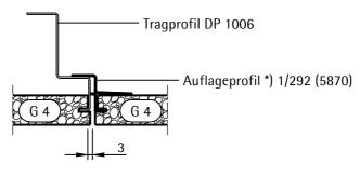
\*) Länge Auflageprofil = Plattenlänge - 3 mm
